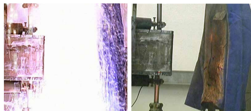
Во время и после испытания - ткань TenCate Tecasafe® Plus.
